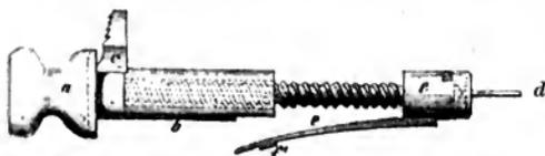
Fig. 1. Nadelbolzen mit Daumenstollen und Sperrfeder.
